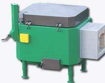
Предназначена для сжигания раздробленных возобновляемых древесных и растительных видов топлива (щепы Р45, некоторые виды опилок, кора, торф, брикет насыпной плотностью до 450 kg/m<sup>3</sup>) относительной влажностью от 25% до 40%
